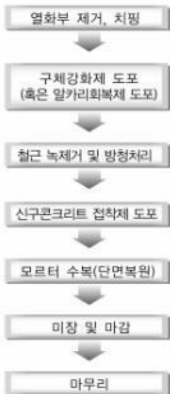
<그림 7.3.10> 단면복구공법(철근방청포함) 개요도
